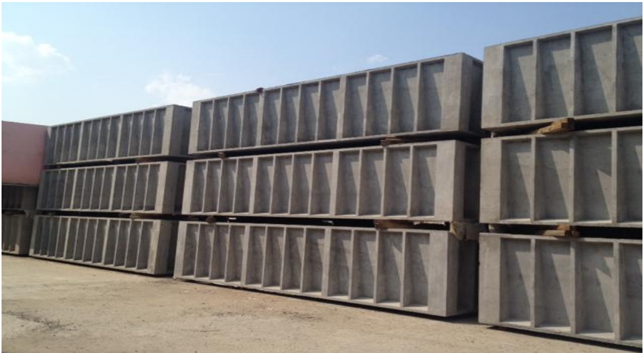
Sử dụng bê tông cốt FRP làm đê chắn sóng dạng container
